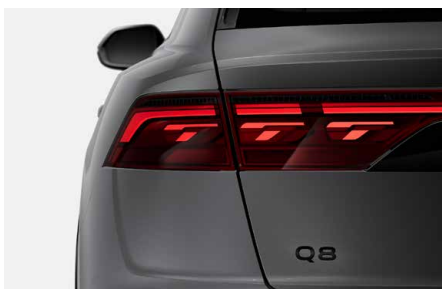
B5C 數位 OLED 尾燈 (包含四種光形變化)
