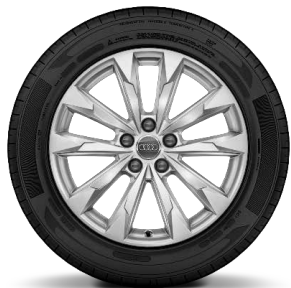
C21 鑄造鋁合金輪圈 搭配 235 / 55 R18 輪胎
