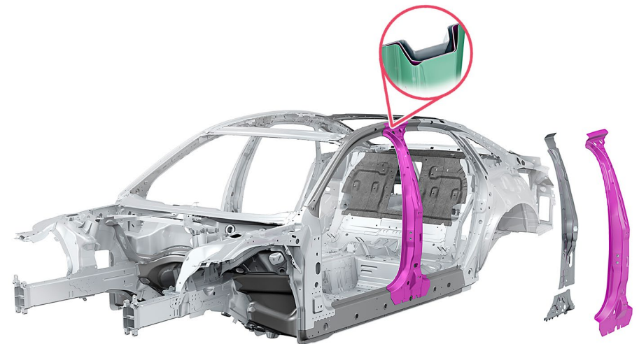
B-Säule mit mehrschaligem Aufbau
