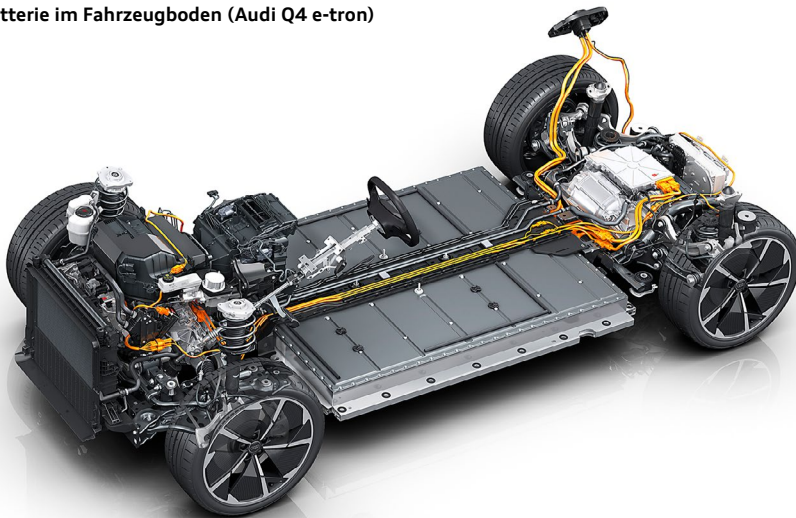
Hochvolt-Batterie im Fahrzeugboden (Audi Q4 e-tron)
