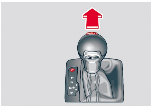
Fahrzeug mit Automatikgetriebe mit Wählhebel: Wählhebel in Stellung „P“ bringen
