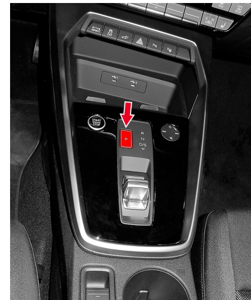
Fahrzeug mit Automatikgetriebe ohne Wählhebel: „P“-Taste drücken
