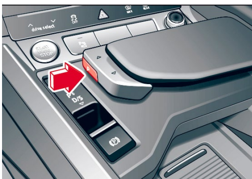
Fahrzeug mit Automatikgetriebe ohne Wählhebel: „P“-Taste drücken
