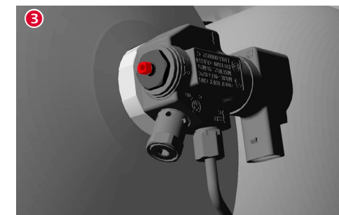
3 Absperrventil mit 5-er Maulschlüssel bzw. Zange oder Spezialwerkzeug im Uhrzeigersinn bis zum Anschlag drehen.
