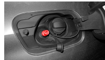
Erdgas-Anschluss am Tankeinfüllstutzen
