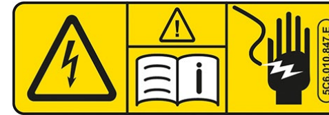
Beispiele für Warnaufkleber in Hochvolt-Fahrzeugen.
