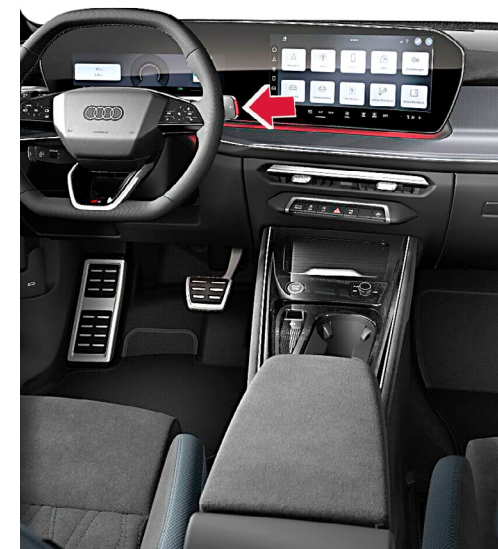
Véhicule avec boîte automatique sans levier sélecteur : appuyer sur la touche « P » du commodo de droite
