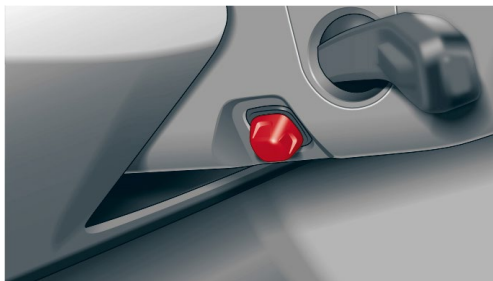
Réglage électrique de la position du volant
