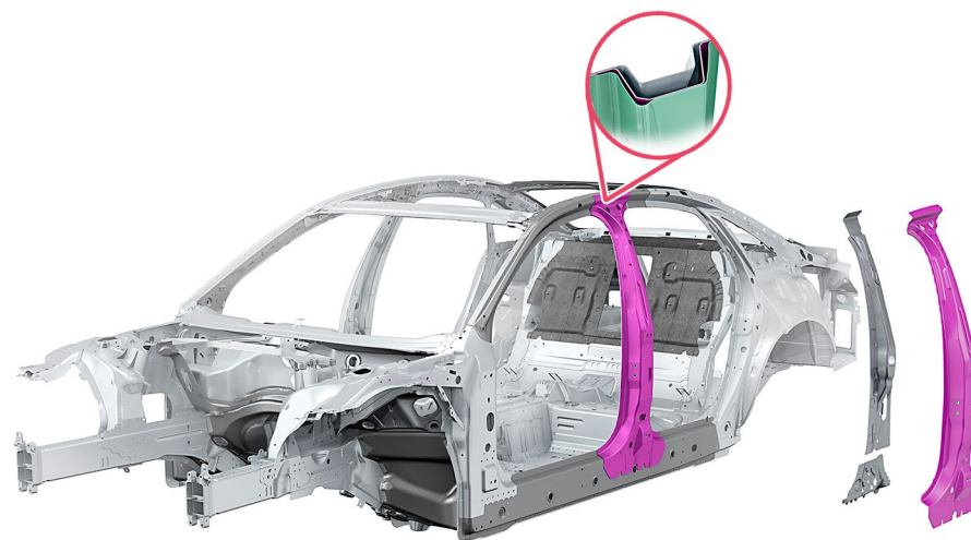
Montant B avec structure multicouches
