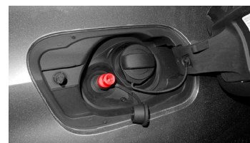
Raccord de gaz naturel sur la tubulure de remplissage du réservoir
