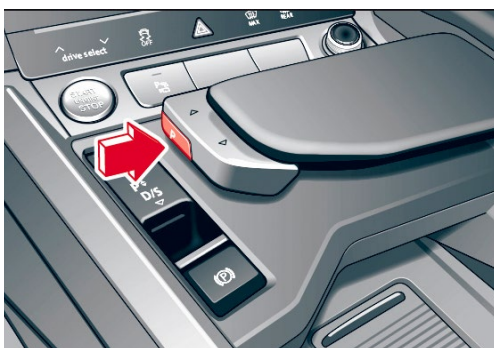
Véhicule avec boîte automatique sans levier sélecteur : appuyer sur la touche « P »
