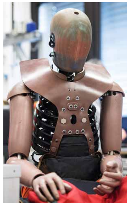
Der THOR-M: die nächste Generation der Dummies für künftige frontale Crashtests. Nachfolger des Dummytyps H3. Er hat bis zu 130 Messpunkte, die Crasheinflüsse und -einwirkungen messen. Sowohl der Brustkorb (Thorax) als auch das Becken wurden verbessert. Gesamtzahl der größeren Einzelteile: etwa 300.
