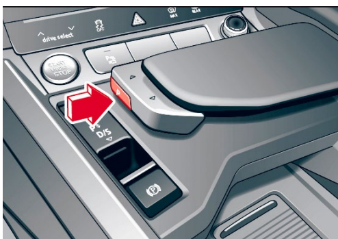
Vehículo con cambio automático sin palanca selectora: pulsar la tecla "P"
