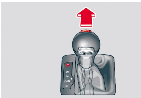
Vehículo con cambio automático y palanca selectora: colocar la palanca selectora en la posición "P"
