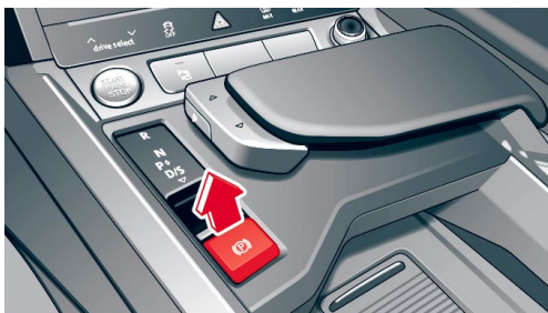
Interruptor del freno de estacionamiento eléctrico
